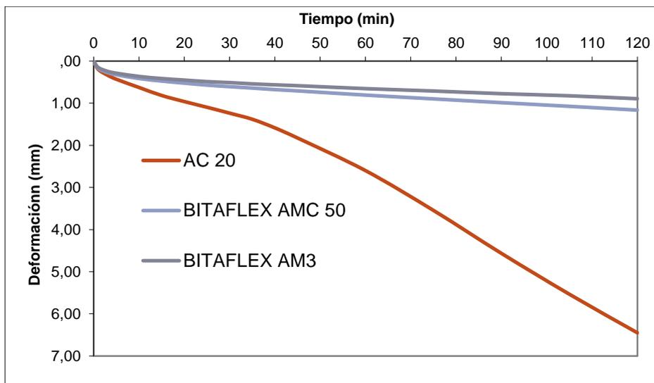
Los componentes del polvo de neumático aportan propiedades adicionales al asfalto como resistencia al envejecimiento y mayor cohesividad a la mezcla.
